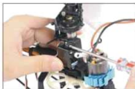
2. 将前后升降伺服器固定 Fix the front and rear ELE servos.
