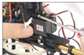
4. 将左右副翼伺服器固定 Fix the left and right AIL servo.
