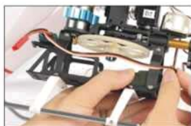
13. 将调速器连接在第三通道 Connect the ESC with CH3.
